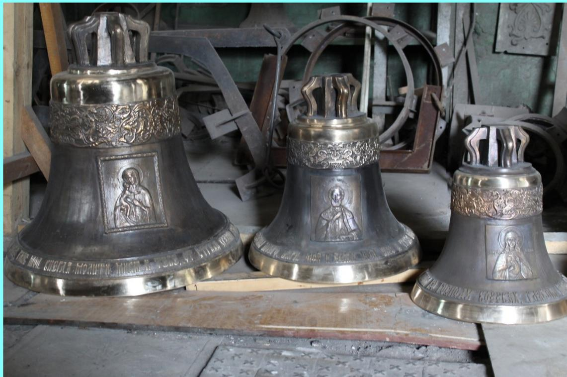
Колокола из сплава колкого чугуна, бронзы и серебра
